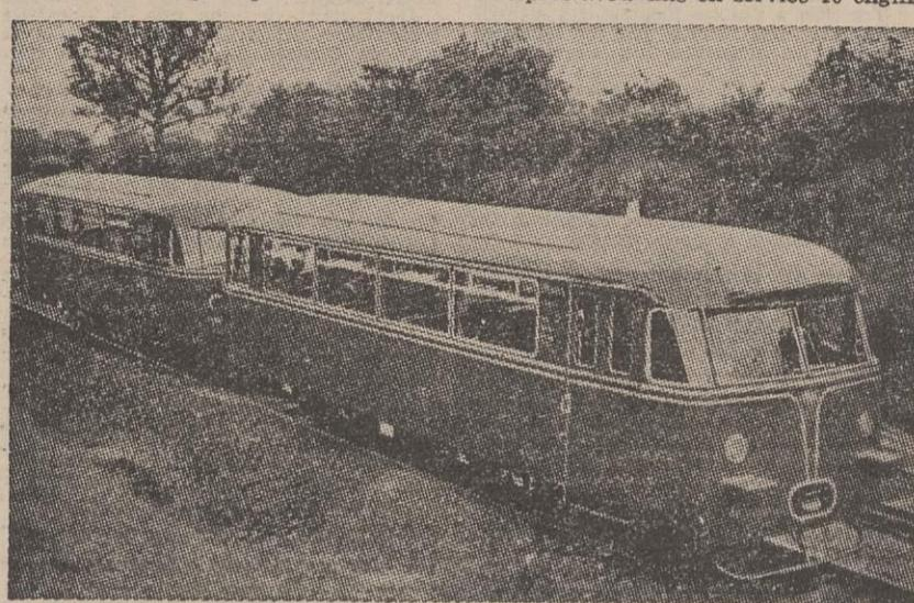
Le châssis est relié aux essieux par des ressorts qui absorbent à la fois les mouvements latéraux et longitudinaux ; la suspension est donc la même qu'en automobile.
