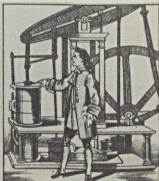
En 1769, James Watt créa définitivement la machine à vapeur telle que nous la connaissons. Au lieu d'employer le vide et la pression de l'air, il employa la vapeur comme moteur sur les DEUX FACES du piston : il inventa le condenseur, la pompe à air, le régulateur, le parallélogramme articulé, etc. etc.
