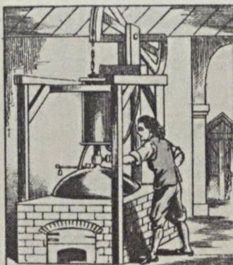
Ce glorieux cylindre à vapeur et à pression d'air de Watt était bien imparfait. En 1781, un modeste serrurier anglais, Newcomen, le perfectionna en inventant la chaudière séparée du cylindre. Mais ces appareils étaient toujours basés sur le vide, puis sur la pression de l'air, et destinés à l'épuisement des mines.
